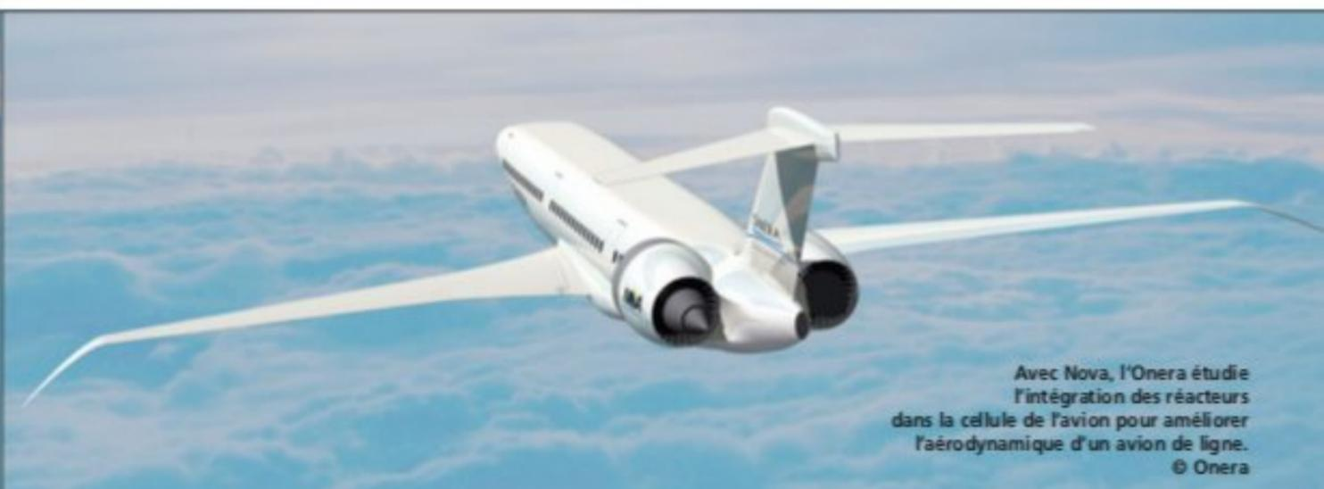
Avec Nova, l'Onera étudie l'intégration des réacteurs dans la cellule de l'avion pour améliorer l'aérodynamisme d'un avion de ligne. © Onera
