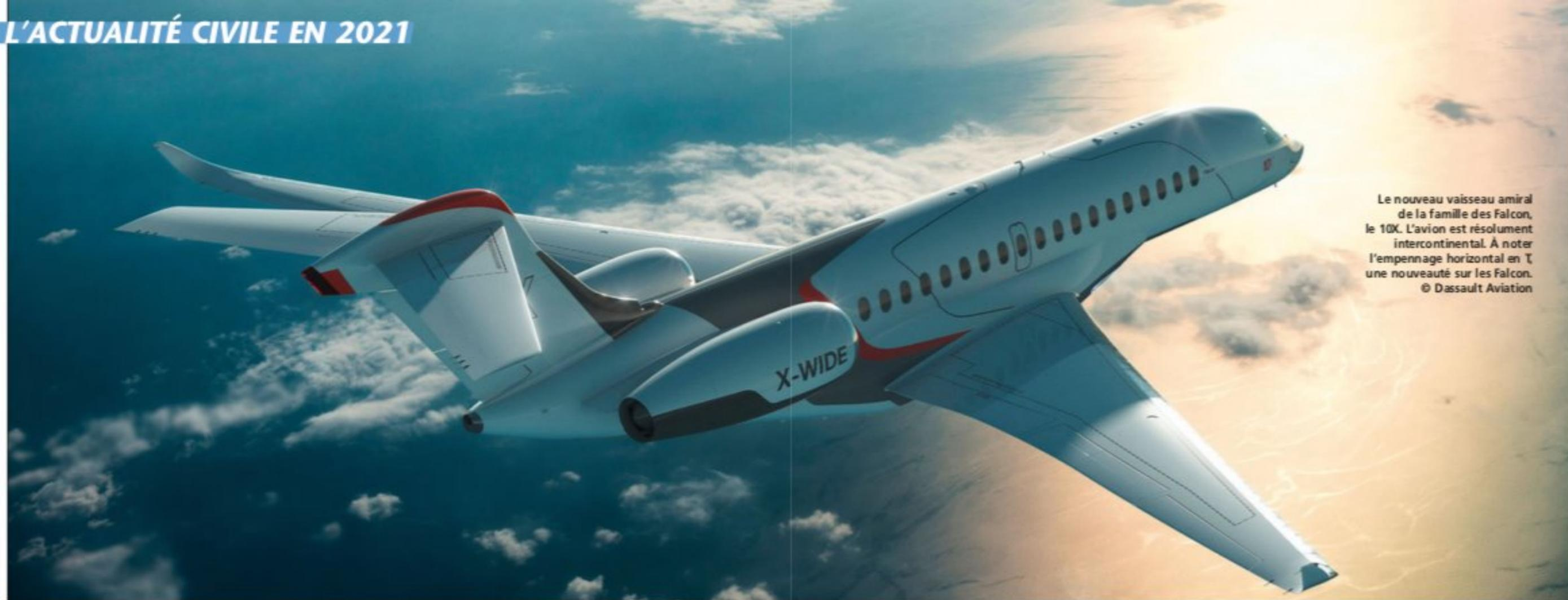
Le nouveau vaisseau amiral de la famille des Falcon, le 10X. L'avion est résolument intercontinental. À noter l'empennage horizontal en T, une nouveauté sur les Falcon.
