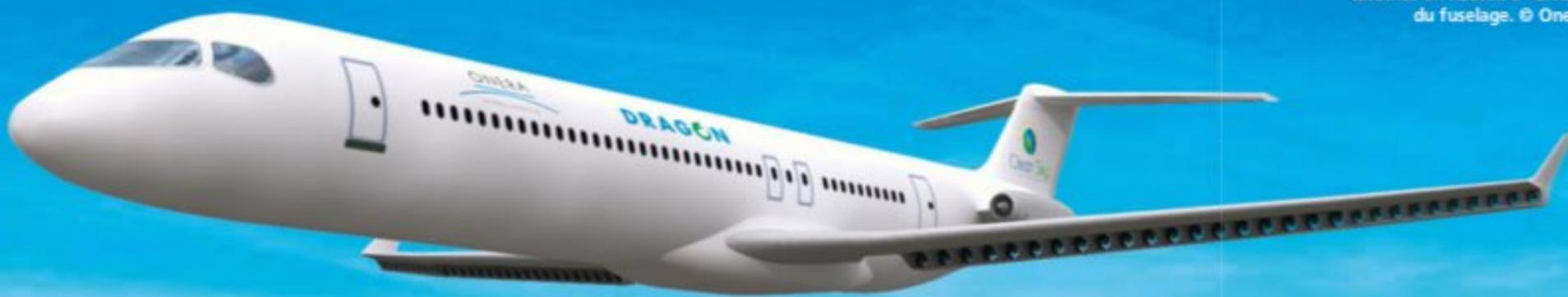
Les chercheurs de l'Onera mènent plusieurs programmes de recherches comme ici Dragon, qui étudie le principe de fans répartis sur toute l'envergure de l'aile. Ils sont propulsés par deux turbines en nacelle à l'arrière du fuselage. © Onera
