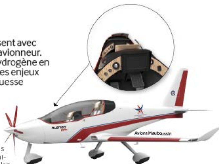
Alérion M1h (2 places). Longueur : 7 m. Envergure : 11 m. Masse à vide : 350 kg. Autonomie : 600 km. Motorisation : 80 kW hybride. Le cockpit (en médaillon).
